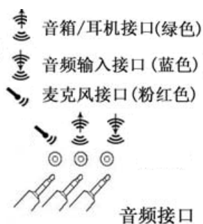
图 3-4 连接音频设备
