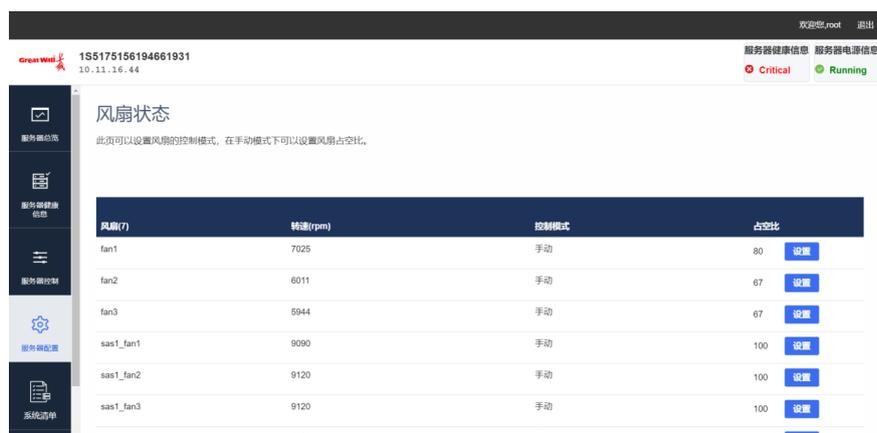
图 6-60 设置占空比后风扇转速变化
