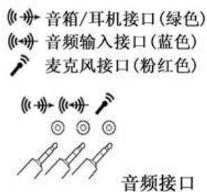
图 3-5 连接音频设备
