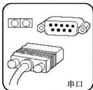
图 3-4 连接串口
