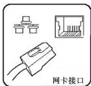
图 3-2 连接网线
