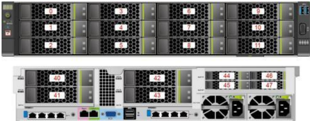
图 3-13 12x3.5 英寸硬盘 EXP 配置硬盘编号
