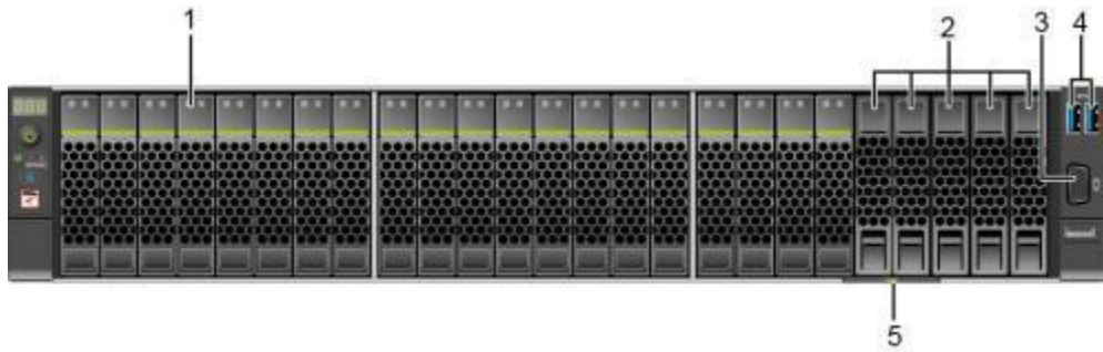
图 3-3 8x2.5 SAS/SATA+12x2.5 NVMe 硬盘配置前面板组件
