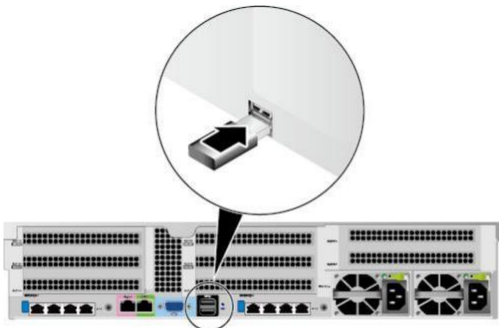
图 6-15 连接 USB 接口
