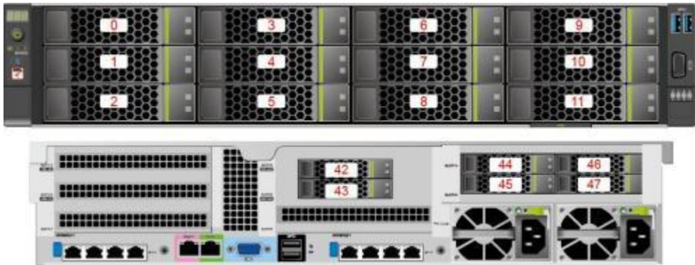
图 3-14 12x3.5 英寸硬盘直通配置
