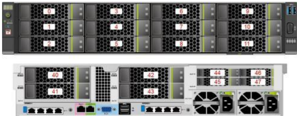
图 3-13 12x3.5 英寸硬盘 EXP 配置硬盘编号
