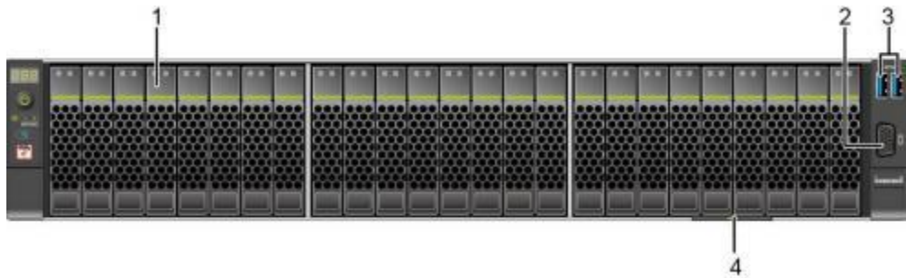
图 3-2 25x2.5 英寸硬盘配置前面板组件
