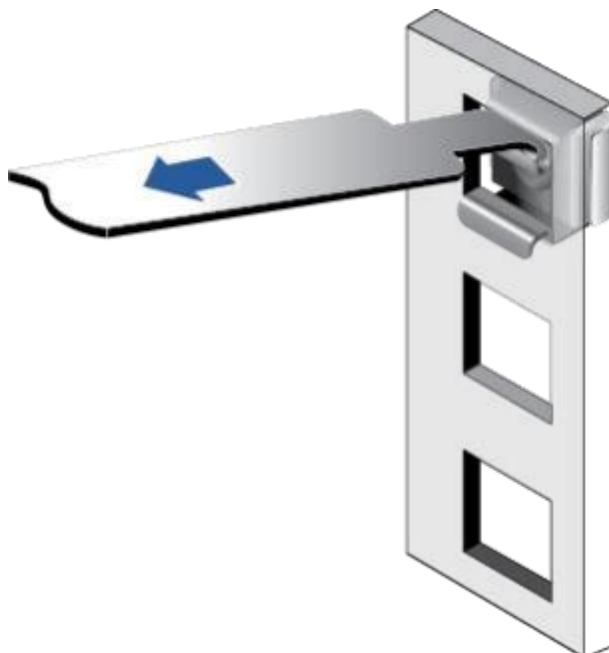
图 6-5 在机柜中安装浮动螺母
