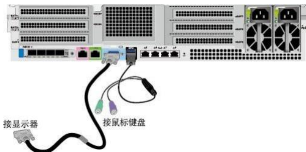
图 5-10 连接USB 转PS2 线缆和VGA 接口
