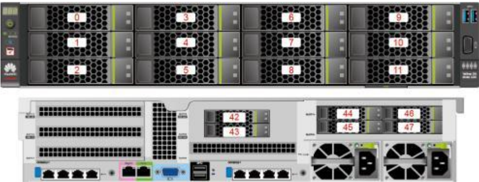
图 7-4 12x3.5 英寸直通硬盘配置
