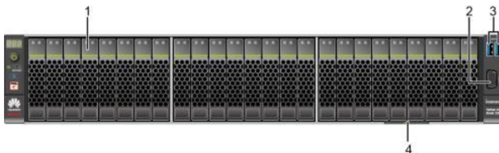
图 5-2 25x2.5 英寸硬盘配置前面板组件
