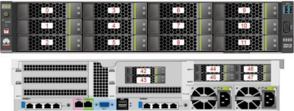
图 5-16 12x3.5 英寸硬盘直通配置
