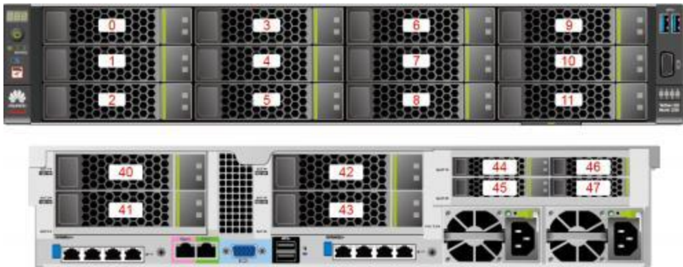
图 5-15 12x3.5 英寸硬盘 EXP 配置硬盘编号
