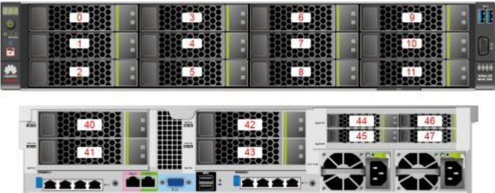
图 7-3 12x3.5 英寸 EXP 硬盘配置
