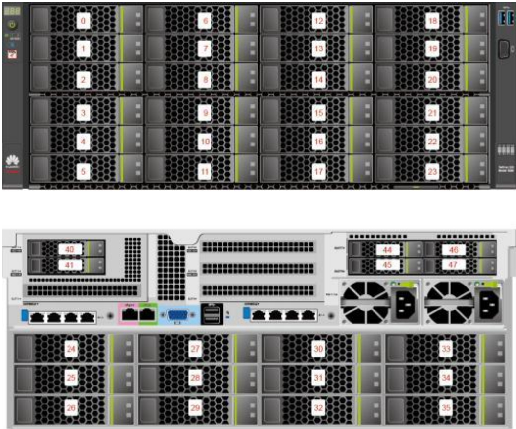
图 6-4 36x3.5 英寸直通机型的硬盘编号
