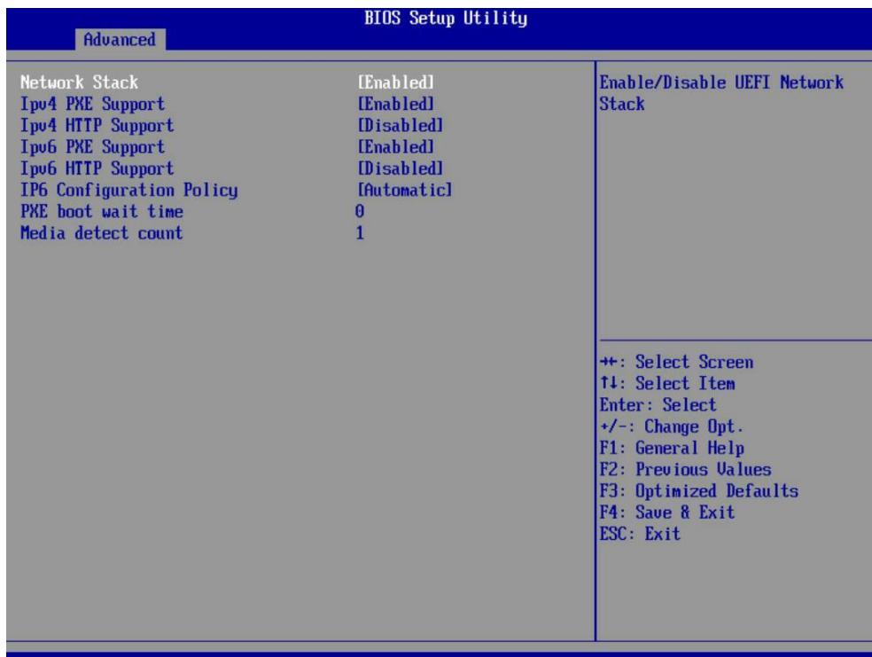
图 3-17 Network Stack Configuration 配置界面
