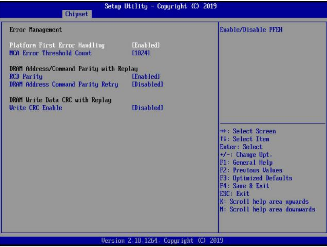
图 3-25 Error Management 配置界面
