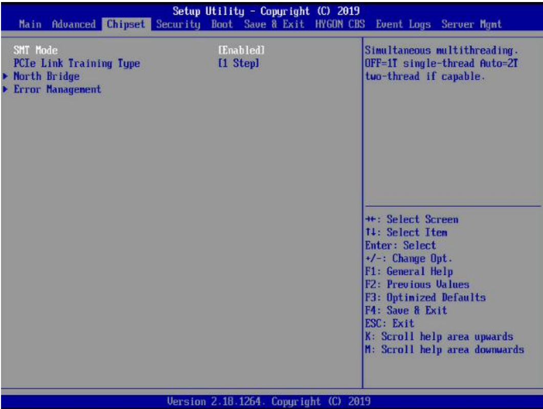
图 3-22 Chipset 配置界面
