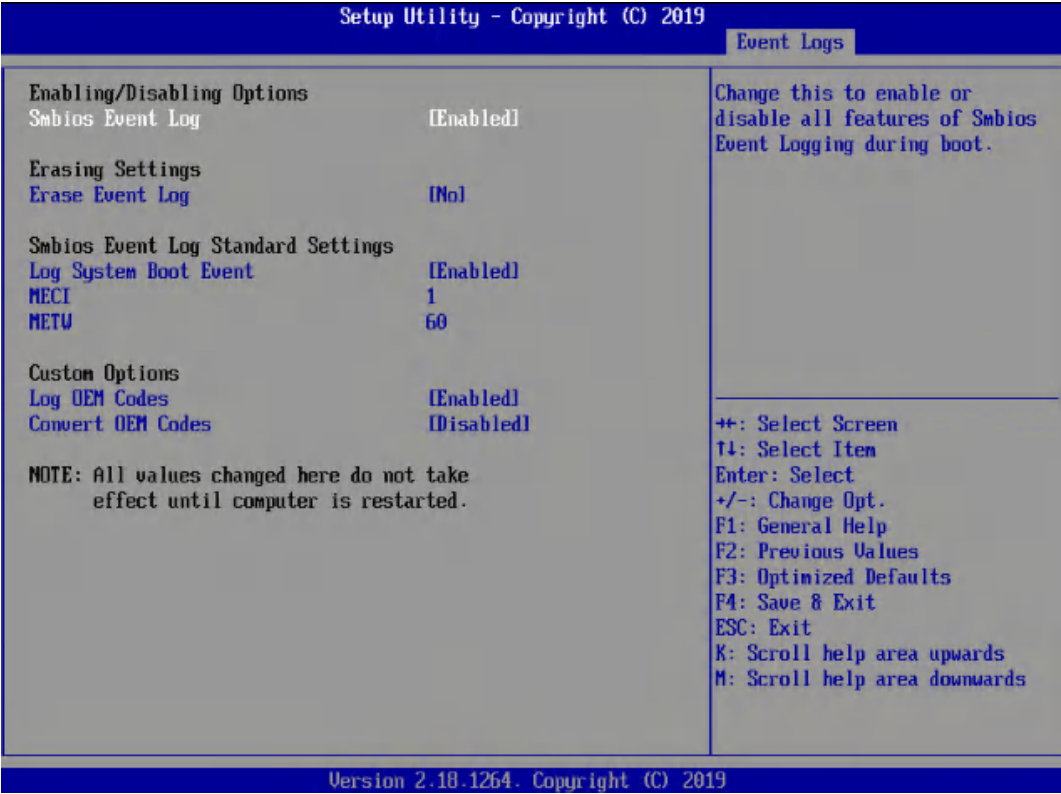
图 3-42 Change Smbios Event Log Settings 配置界面
