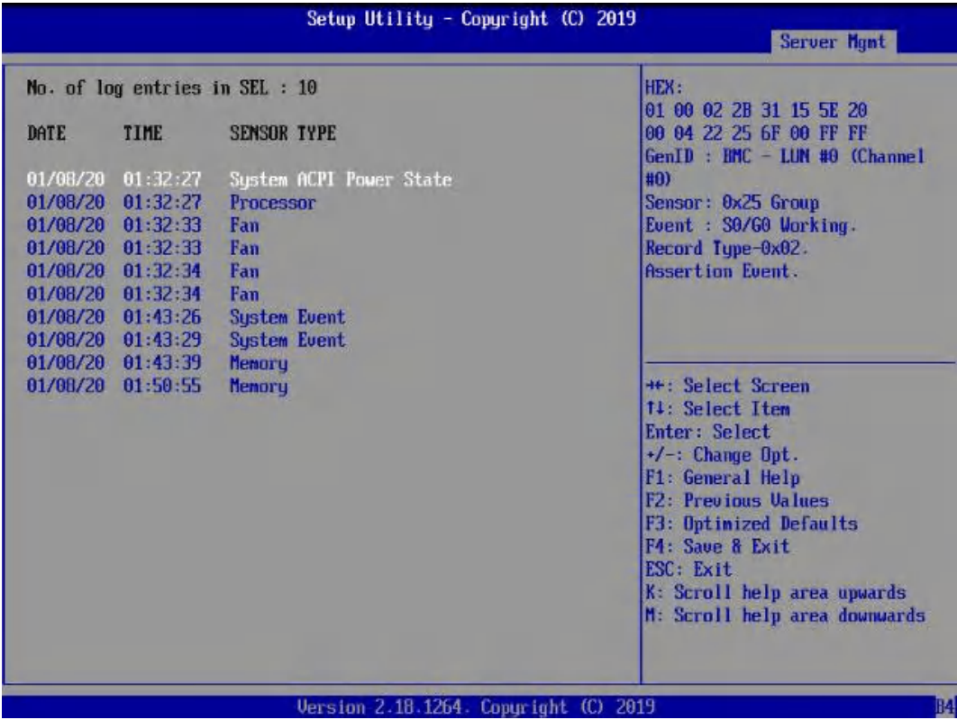
图 3-47 View System Event Log 配置界面
