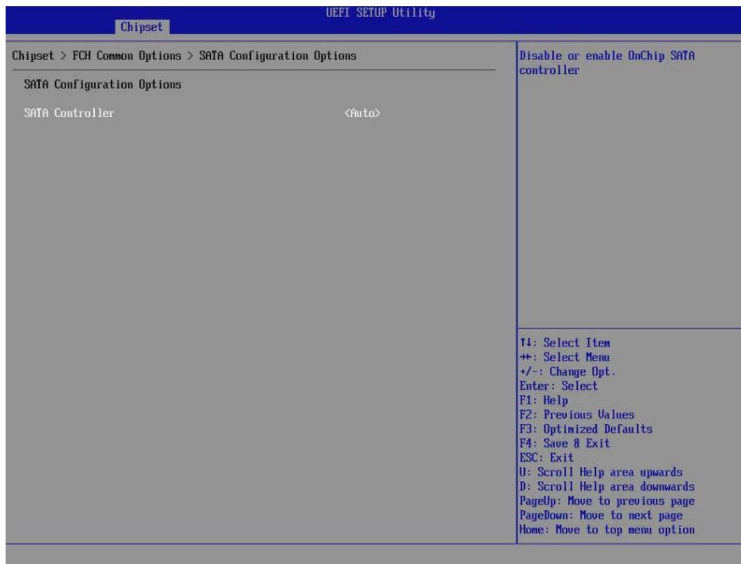
图 3-52 SATA Configuration Options 配置界面
