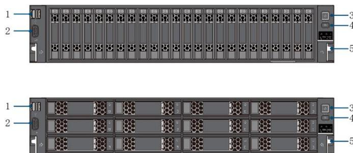
1、USB 2、VGA 3、Power Button 4、UID Button 5、箱耳
