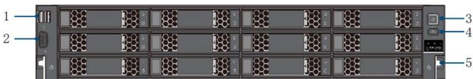
1、USB 2、VGA 3、Power Button 4、UID Button 5、箱耳
