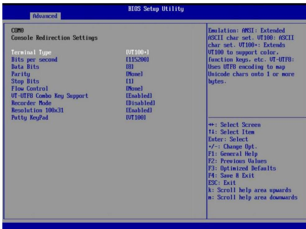
图 3-10 (COM0) Console Redirection Settings 配置界面
