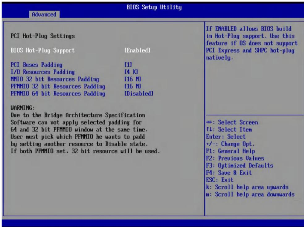
图 3-17 PCI Hot-Plug Settings 配置界面
